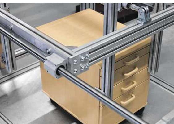
Hunderte Male wird der Rollcontainer hin und her geschoben. Der Sessel muss den Druck der Prüfstempel aushalten
