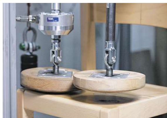
Hunderte Male wird der Rollcontainer hin und her geschoben. Der Sessel muss den Druck der Prüfstempel aushalten
